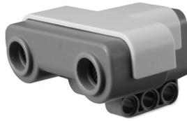
Figura 4.9: Il sensore ad ultrasuoni.
