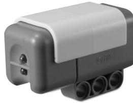
Figura 4.7: Il sensore di luce.
