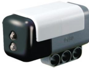
Figura 4.11: Il sensore di colore.
