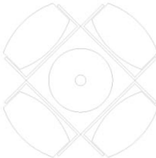
**Figura 4: Schema semiruota con supporti “a forcella”.**
