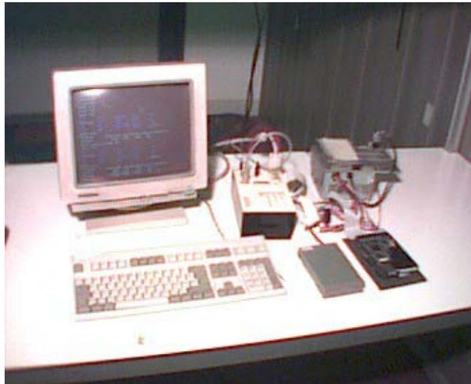
Il nostro lavoro è stato sviluppato sul calcolatore che poi verrà montato a bordo di MARMOT. Ovviamente per poter lavorare abbiamo dovuto collegare ad esso un monitor, una tastiera, un alimentatore, un lettore floppy, hard disk ed un lettore cd-rom.
