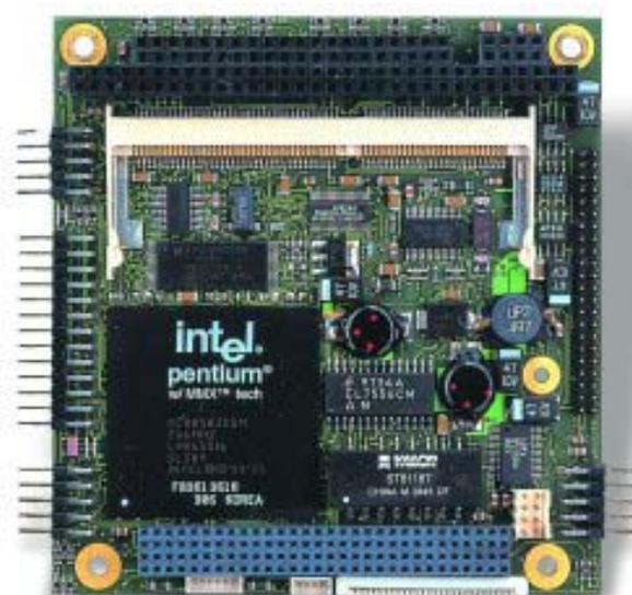
Il MOPSlcd6 (Minimized Open PC System) con il suo processore Intel Pentium MMX a 166 MHz offre alte prestazioni ed affidabilità. Visto il basso consumo di potenza (meno di 9 watt) non è necessaria una ventola di raffreddamento – un
