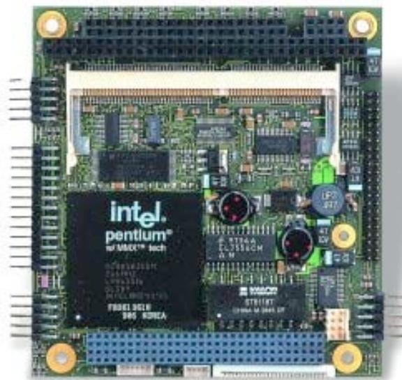
Il PC104 da noi utilizzato è composto di un sistema MOPSlcd-6 della JUMPtec Industrielle Computertechnik equipaggiato con un chipDISK-IDE da 32 MB prodotto dalla stessa industria e con 64 MB di memoria RAM.
