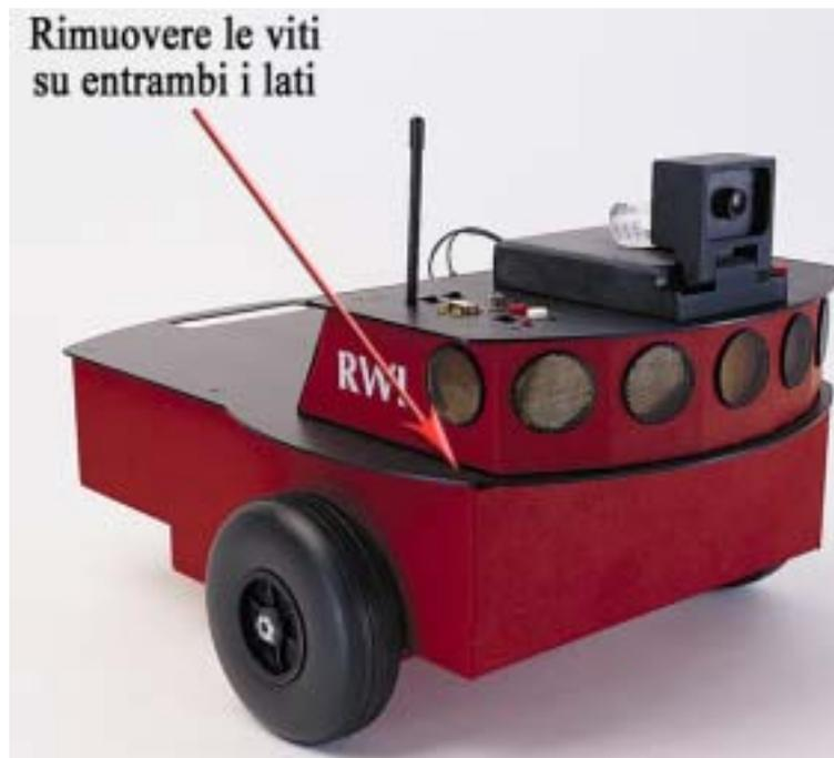
Una volta rimosse le due viti indicate, si può procedere al fissaggio della struttura portante dei sensori Figaro Tgs822:
