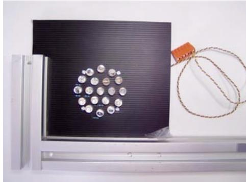
**Figura 9: Struttura su cui sono montati i LED.**
