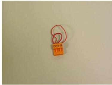
**Figura 28 : Connettore per il cortocircuitamento dei fincorsa.**
