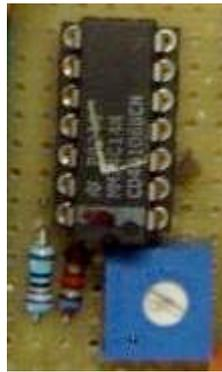
Figura 13 : Foto componenti per gestione fotocellula
