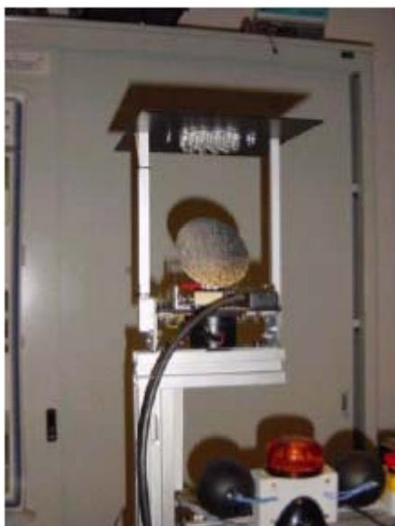
Figura 1.6: sistema marker attivo posto sull'estremità del robot Morgul.
