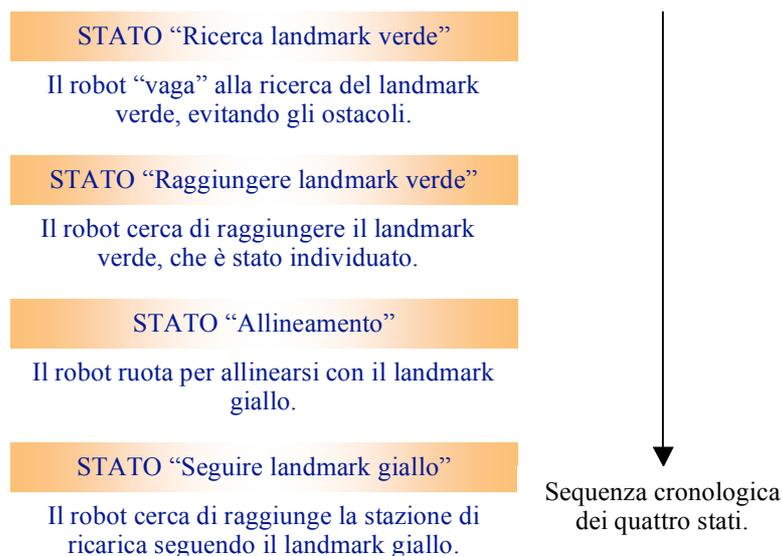
Figura 8. Schematizzazione dell’architettura a stati.
