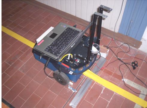
Figura 22. Il sistema ha funzionato correttamente e Speedy si è posizinato nella sua stazione di ricarica.
