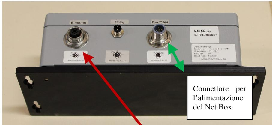
Fig. 9 - Il Net Box visto frontalmente
