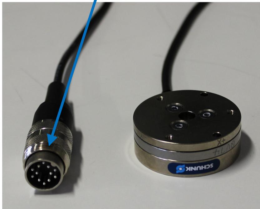
Fig. 12 - Il sensore di forza a destra con il suo connettore
