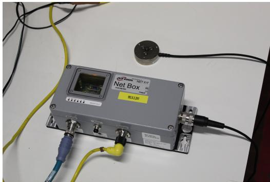
Fig. 8 - Il sensore di forza con il relativo Net Box presente in laboratorio ARL
