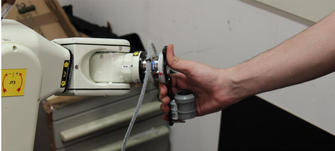
Fig. 1 - Manipolatore industriale guidato attraverso l'applicazione di una forza sul suo end effector
