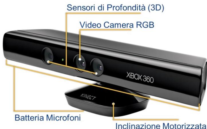
**Fig. 1 - Dispositivo Microsoft Kinect**
