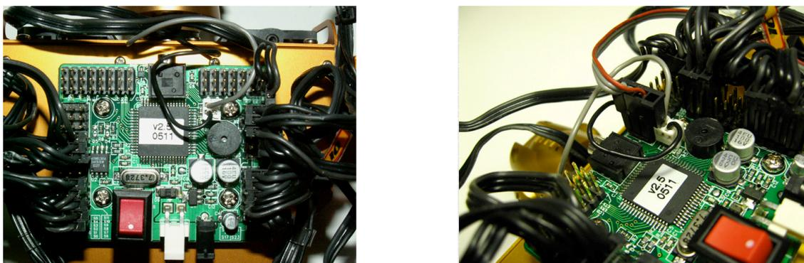
Figura 8: primo piano del microcontrollore e del collegamento con il potenziometro
