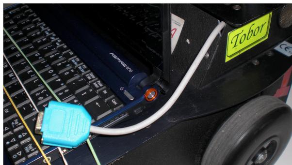
Una volta fatta questa operazione ci si è resi conto che il connettore portato all'esterno era femmina; dal momento che tale connettore doveva essere inserito all'interno della presa seriale posta sul pannello superiore della Console di Tobor, è stato necessario realizzare un adattatore maschio-maschio, poiché tale presa seriale era femmina anch'essa.
