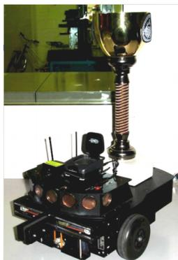
Dall'immagine si nota come sulla schiena del robot sia fissata una "coppa trofeo" che rende impossibile l'installazione del calcolatore "on-board"; pertanto, si è resa necessaria la rimozione dell'oggetto in questione.
