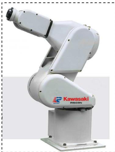
La figura a lato (Fig. 1) mostra il manipolatore RS03N. Grazie al suo design compatto unito all'elevata velocità dei movimenti dei giunti l'RS03N è il manipolatore ideale per una larga gamma di applicazioni. Nell'immagine è possibile anche individuare i vari giunti e le relative parti meccaniche che li collegano (link).
