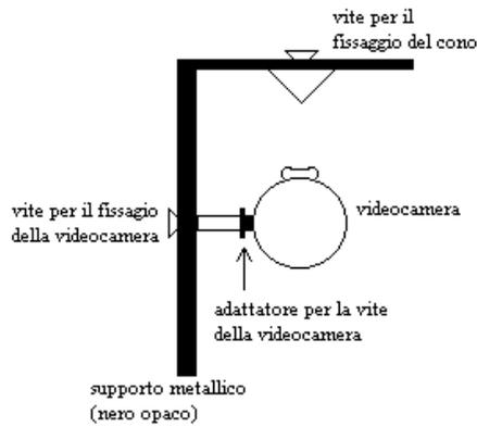
Esso è costituito da un supporto metallico di colore nero opaco a forma di L. L'opacità ha la funzione di evitare riflessioni che agiscono da disturbo sull'immagine acquisita. Sul lato più corto è fissato il cono attraverso una vite; sul lato più lungo è fissata la telecamera. Si è reso necessario l'utilizzo di un adattatore per la vite da inserire nella telecamera in modo da fissarla. La vista dall'alto si presenta nel modo indicato dalla figura seguente.
