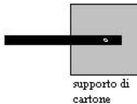
Un supporto quadrato di colore grigio opaco è inserito tra il supporto e la base del cono, per evitare che fonti di luce situate sul soffitto negli ambienti di utilizzo possano mandare in saturazione la telecamera, che acquisirebbe in questo modo una immagine con la presenza di grandi macchie bianche, corrispondenti alle zone direttamente colpite dalla luce.
