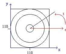
La corona circolare viene così mappata in una matrice di dimensioni 120\*360 per ogni componente cromatica, indipendentemente dai valori di RMIN e RMAX. Per ogni pixel di coordinate (r,t) in questa matrice sono calcolate le coordinate (x,y) del pixel nella immagine originale del cono che gli corrisponde secondo le relazioni:
