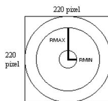
`RMIN` e `RMAX` sono rispettivamente i raggi interno ed esterno della corona, fissati di default in 60 e 90 pixel rispettivamente. Sulla corona circolare così ottenuta è applicata una trasformazione del sistema di riferimento da cartesiano a polare. Gli assi cartesiani `x` e `y` e il riferimento polare `r` e `t` sono posizionati rispetto alla corona circolare nel modo indicato dalla figura seguente:
