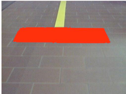
Figura 12: Riconoscimento del marker verde con colorazione del blob corrispondente
