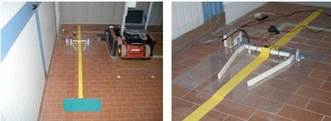
Figura 1: Dettaglio della stazione di ricarica e dei due oggetti da riconoscere
